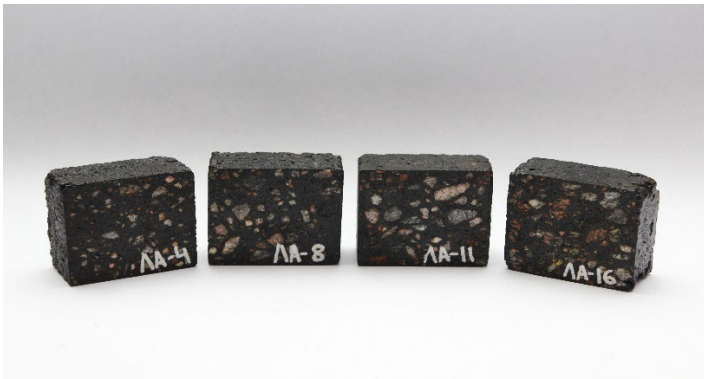
Рис. 1. Образцы-кубы из литых асфальтобетонов в разрезе
