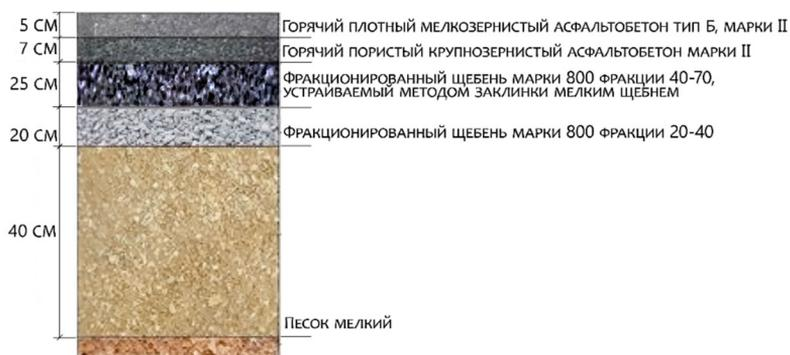
**Рис. 6. Эталонная конструкция дорожной одежды автомобильных дорог III категории**
