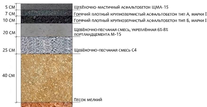
**Рис. 5. Эталонная конструкция дорожной одежды автомобильных дорог I категории**
