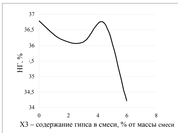
Рис. 6. Влияние содержания гипса на водопотребность вяжущего
