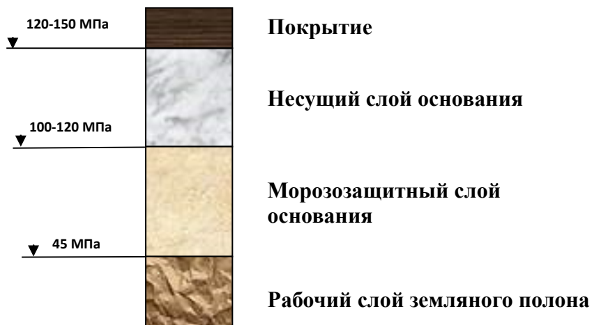
Рис. 1. Принципиальная схема типовой конструкции дорожной одежды (RStO 01, Германия)
