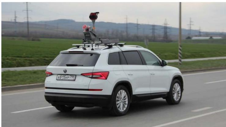
*Рис. 3. Система мобильного лазерного сканирования Alpha 3D, установленная на автомобиль*
