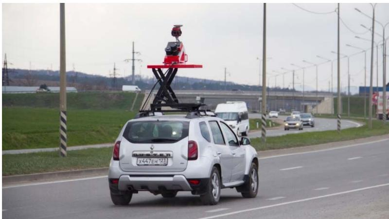
*Рис. 4. Система мобильного лазерного сканирования АГМ-МС7 на подъемной платформе, установленная на автомобиль*
