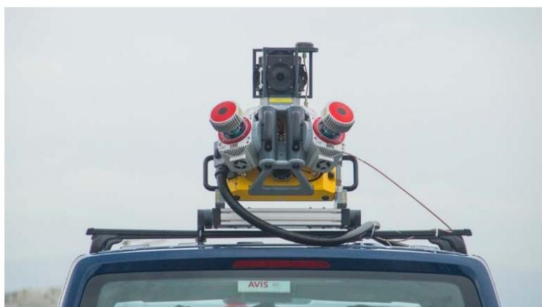
*Рис. 6. Система мобильного лазерного сканирования MX9*
