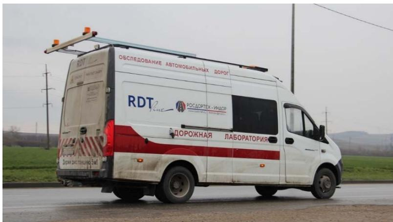
*Рис. 5. Измерительный комплекс аэродромно-дорожных лабораторий КП 514 РДТ*
