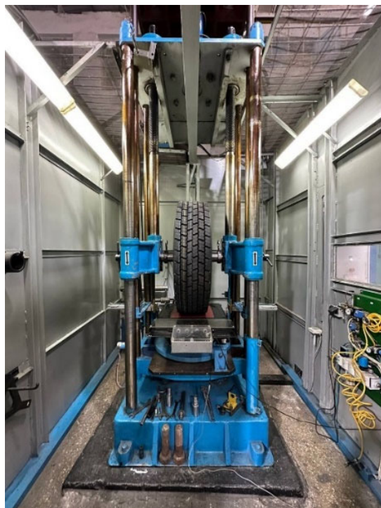
Рис. 1. Лабораторная установка для измерения контактного давления шины грузового автомобиля
