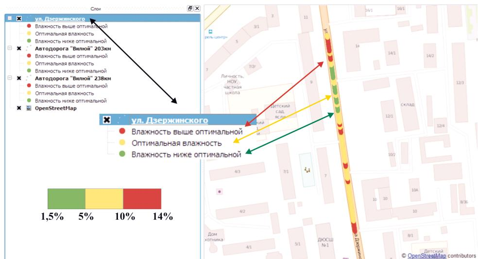
*Рис. 12. Представление результатов оценки влажности грунтов автомобильной дороги по ул. Дзержинского (г. Якутск)*
