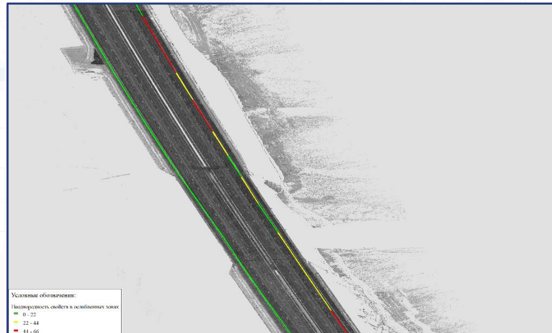
Количественная оценка состояния рабочего слоя дорожной конструкции по данным георадара
