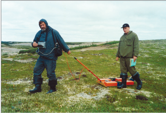
Фото 1. Георадарные обследования на территории Ямало-Ненецкого округа контактными антенным блоком АБ-250
