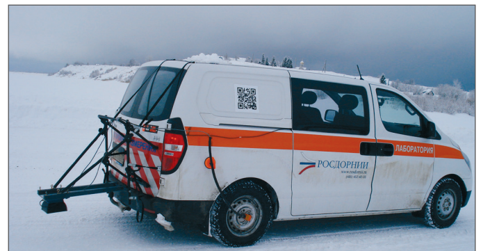
Фото 2. Георадарные обследования ледовой переправы через Северную Двину рупорным антенным блоком АБ-1700Р
