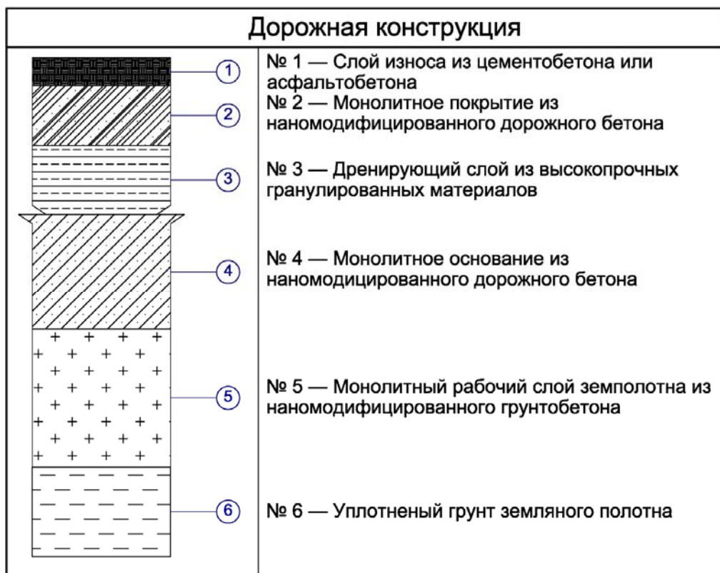
Рис. 9. Долговечная дорожная конструкция автомобильных дорог, сроком эксплуатации 35-50 лет в климатических условиях Казахстана, в соответствии с патентом Республики Казахстан [22]:
