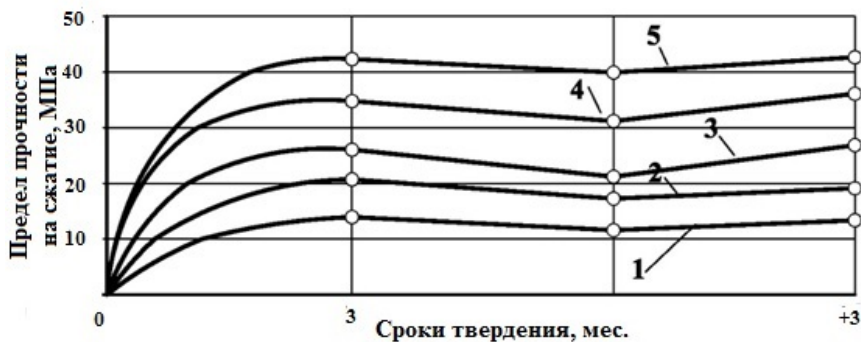
Рис. 7. Самовосстановление прочности дорожного бетона, испытанного на морозостойкость (МРЗ-200), в зависимости от количества белитового цемента:
