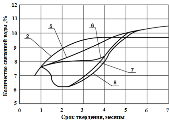
Рис. 5. Кинетика изменения количества прочносвязанной воды в образцах белитового цементного камня в процессе твердения при различных температурах:
