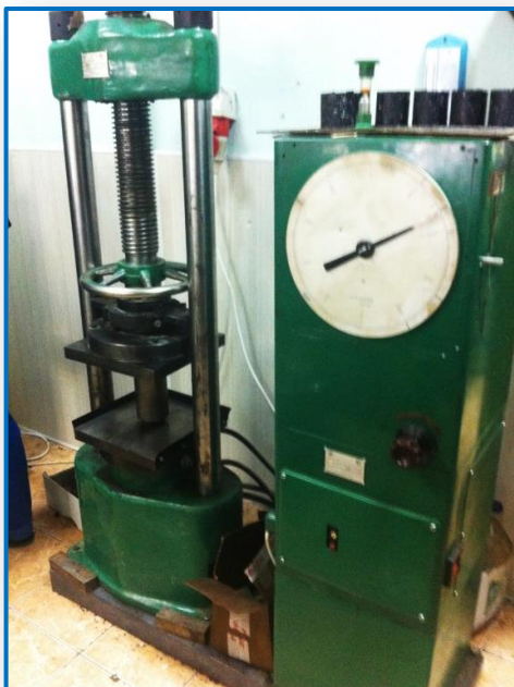
Статическое уплотнение в течении 3-х минут под давлением 40 МПа
