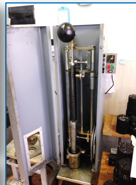
Динамическое уплотнение под воздействием падающего груза
