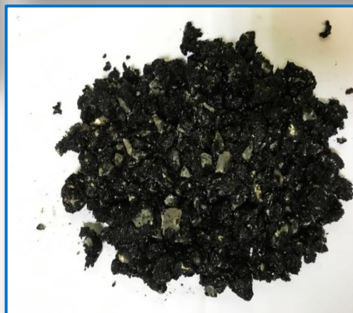
Статическое уплотнение в течении 3-х минут под давлением 40 МПа
