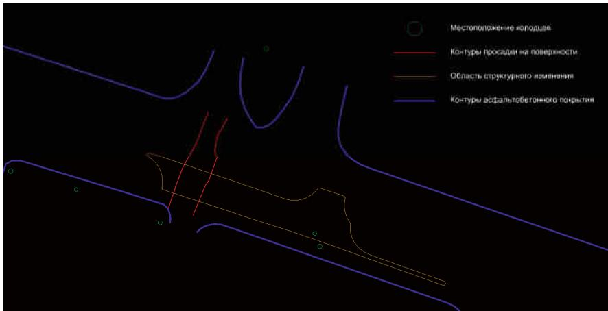
*Рис. 20. Результаты георадиолокационного обследования участка деформации дорожного покрытия*
