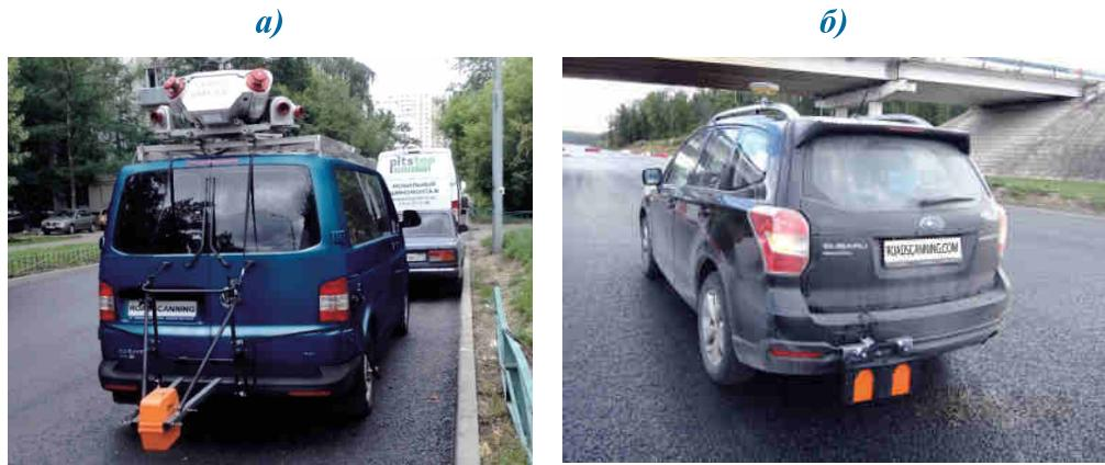
*Рис. 2. Внешний вид мобильных лабораторий для геопространственного моделирования георадарных данных:*
