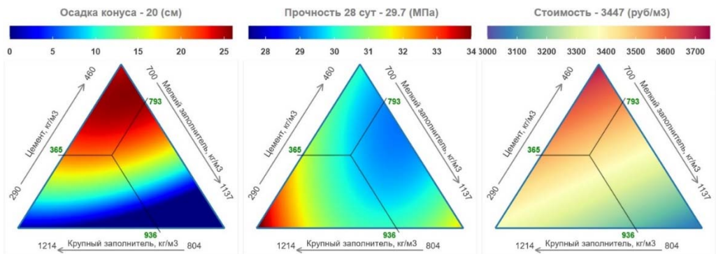
Рис. 5. Вид диаграмм при фиксированном водоцементном отношении В/Ц = 0,59
