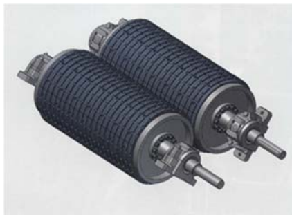
Рис. 2. Рабочие органы гранулятора компании Venninghoven:
