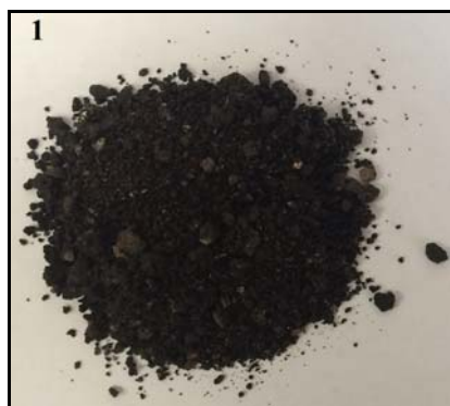
Рис. 6. Дробленый асфальтовый гранулят: а) - до гранулирования; б) - после гранулирования
