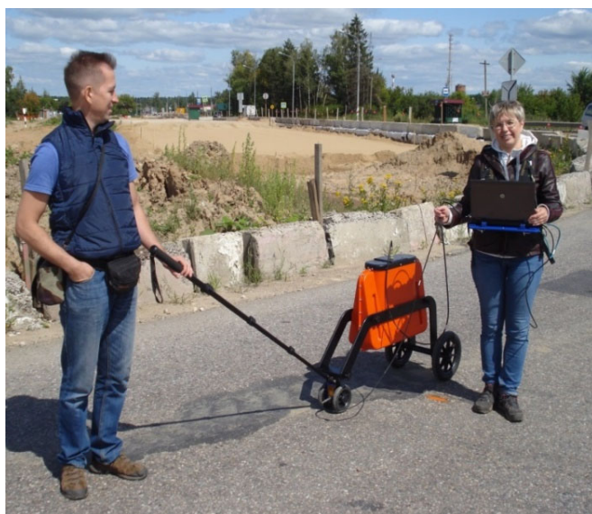
Рис. 1. Импульсный георадар «ОКО-3»
