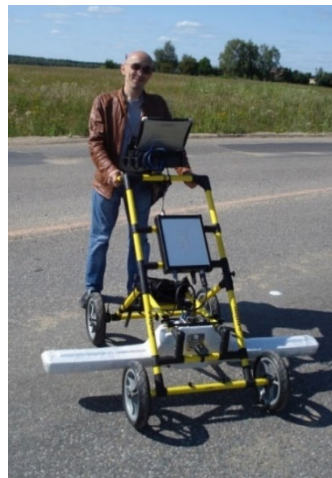
Рис. 2. Импульсный георадар «Акула-9000С» (Швеция)
