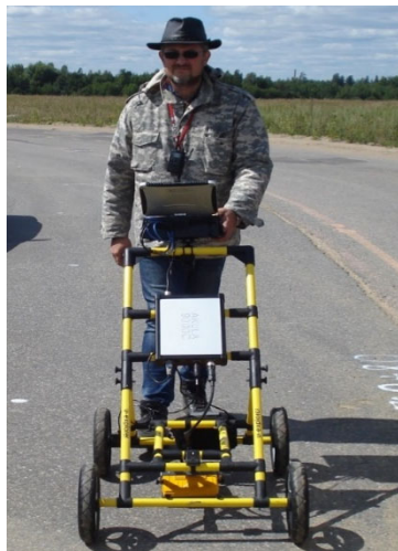
Рис. 2. Импульсный георадар «Акула-9000С» (Швеция)
