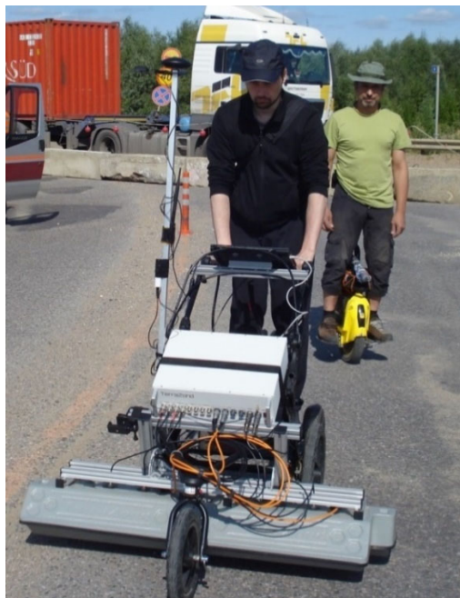
Рис. 6. Георадиолокационное оборудование «ГРТ-22»
