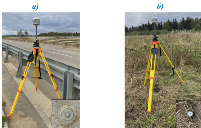
Рис. 2. Выполнение ГНСС-измерений на опытном-экспериментальном участке и общий вид центра геодезического пункта: а) пункт ВОГС; б) опорный пункт
