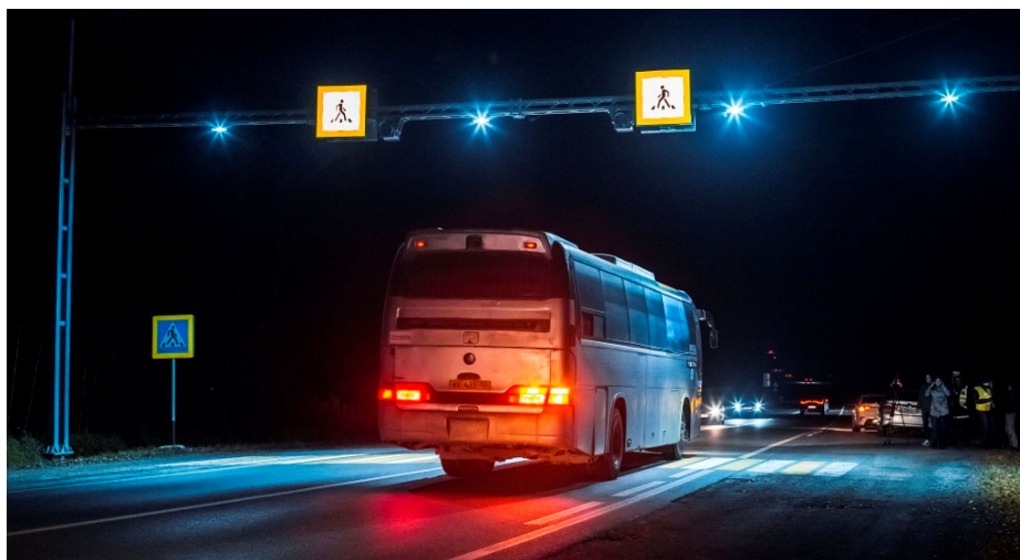
Рис. 4. Внешний вид пешеходного перехода с проекционной разметкой в темное время суток
