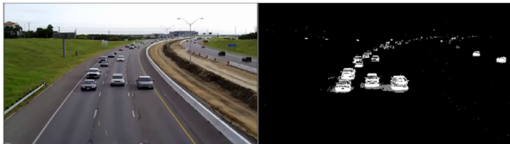
Рис. 5. Результат выделения заднего фона и применения полученной маски к изображению
