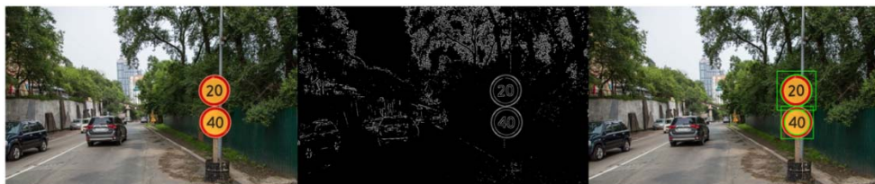
Рис. 1. Последовательность обработки изображения при решении задачи по детектированию дорожных знаков
