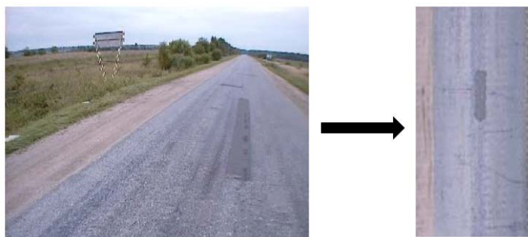
Рис. 7. Построение развертки дороги [14]
