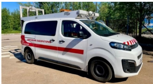
Рис. 1. Передвижная дорожная лаборатория «АДС-МАДИ» (фотоснимок авторов)
