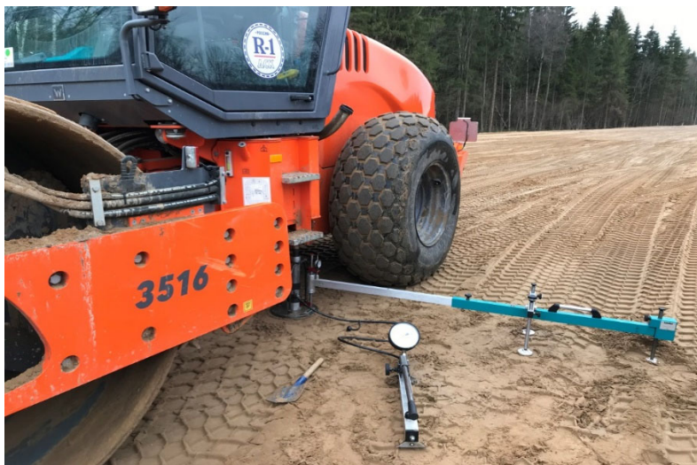
Рис. 2. Испытание штамповой установкой статического нагружения
