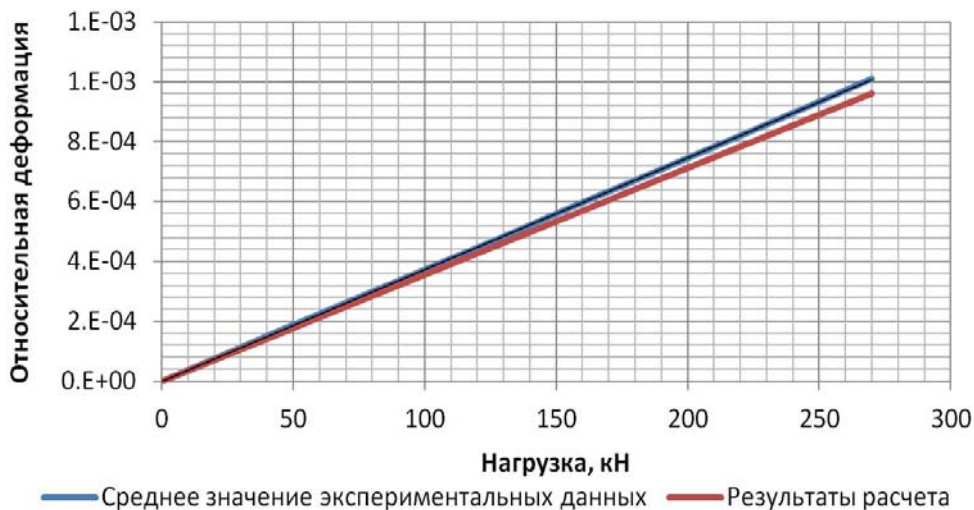
Рис. 16. Сравнение значений деформаций в верхнем поясе
