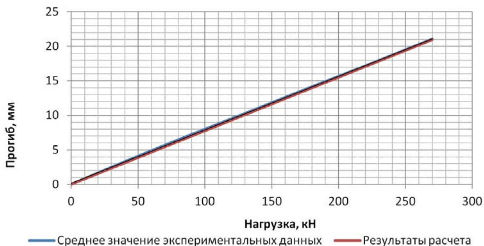
Рис. 17. Сравнение значений прогибов в середине пролета
