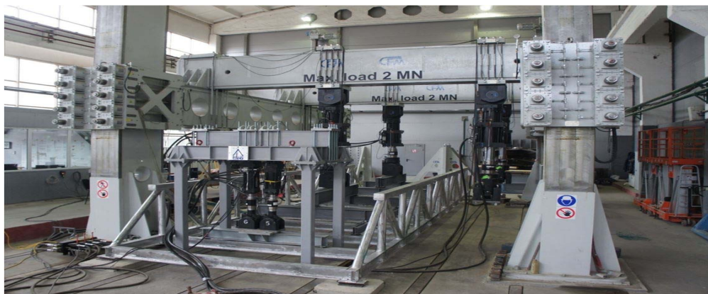
Рис. 4. Каркас моста, установленный в испытательную раму
