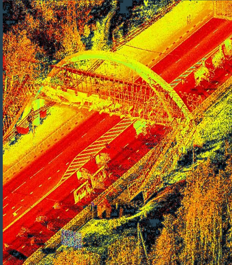
Детальный вид облака точек лазерного сканирования в изометрическом изображении на примере надземного пешеходного перехода
