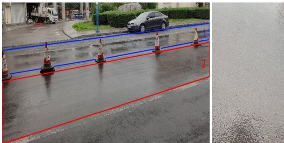
Рис. 5. Схема расположения опытных участков, устроенных на модифицированных регенерированных холодных смесях: 1 – BE + C; 2 – BE, ER+H, ESBO
