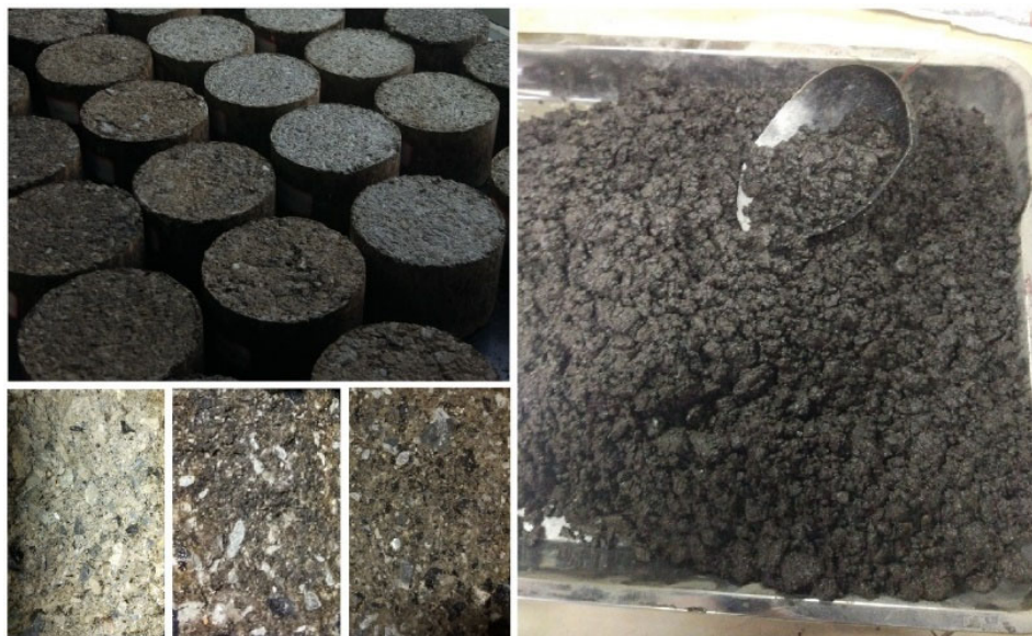
Рис. 2. Структура композитов и модифицированная холодная регенерированная смесь на основе асфальтогранулята
