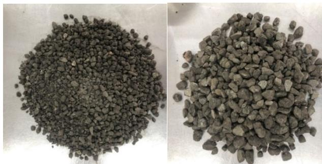
*Рис. 2. Пробы RAP, отобранные на асфальтобетонном заводе*
