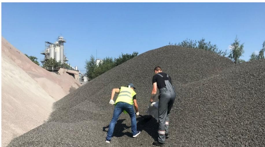
*Рис. 1. Отбор проб RAP на асфальтобетонном заводе*
