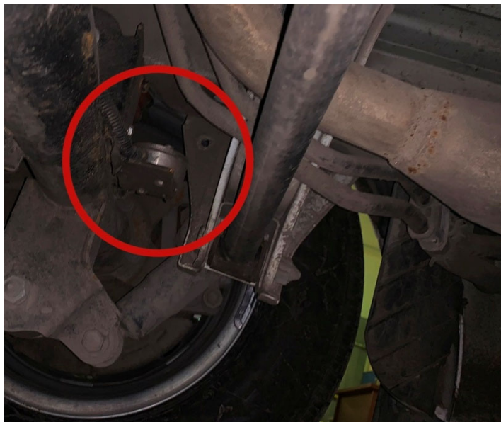
Рис. 2. Датчик для измерения ускорений на автомобиле Ford (АДК-М)
