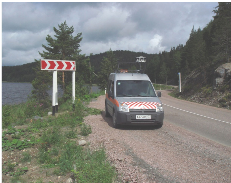
Рис. 1. Автомобильно-дорожный комплекс АДК-М на базе автомобиля Ford
