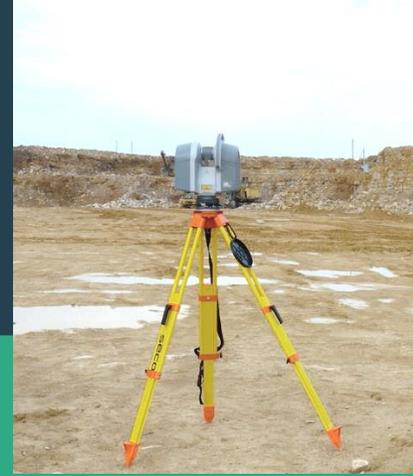
Наземное лазерное сканирование
