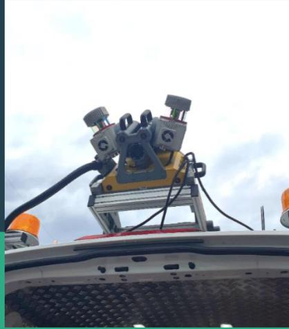
Мобильное лазерное сканирование
