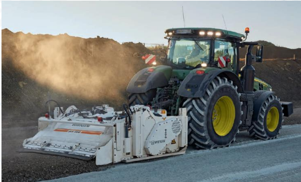
Ресайклеры-стабилизаторы грунта навесные, ширина фрезерования до 2500 мм
