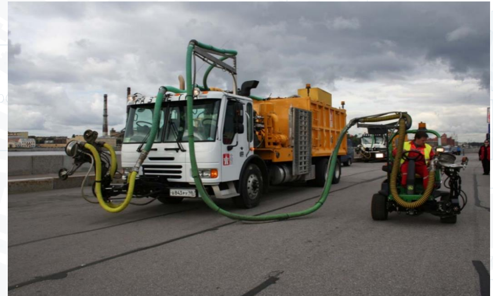
Машины для удаления дорожной разметки гидравлическим методом на шасси автомобильного типа, объем цистерны для воды 12 м3, объем цистерны для отходов 6 м3
