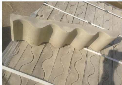
1. Блоки железобетонных лотков для защиты спиральновитых труб
