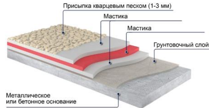
3. Комплекс материалов для устройства гидроизоляции плит проезжей части мостовых сооружений полимерными мастиками: полиуретановые грунтовки для бетонных и металлических поверхностей, полиуретановая мастика, добавка ускорения полимеризации и кварцевый песок фракции 1-3 мм
