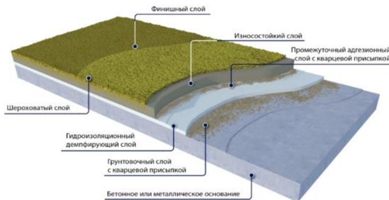
5. Комплекс материалов для устройства полимерного тонкослойного покрытия на основе полиметилметакрилата (ПММА) на железобетонном или металлическом основании тротуаров мостовых сооружений: грунтовки на основе ПММА для бетонных и металлических поверхностей, добавка (инициатор полимеризации), смолы на основе ПММА для демпфирующего и износостойкого слоя, лак на основе ПММА, кварцевый песок различных фракций
