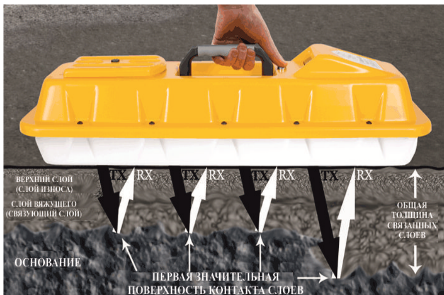
Рис. 1. Пример обследования дорожной конструкции прибором E-spot
