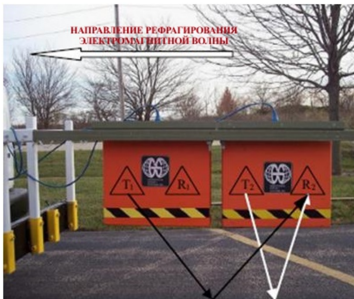
Рис. 6. Бесконтактный антенный блок, работающий по методу общей глубинной точки
