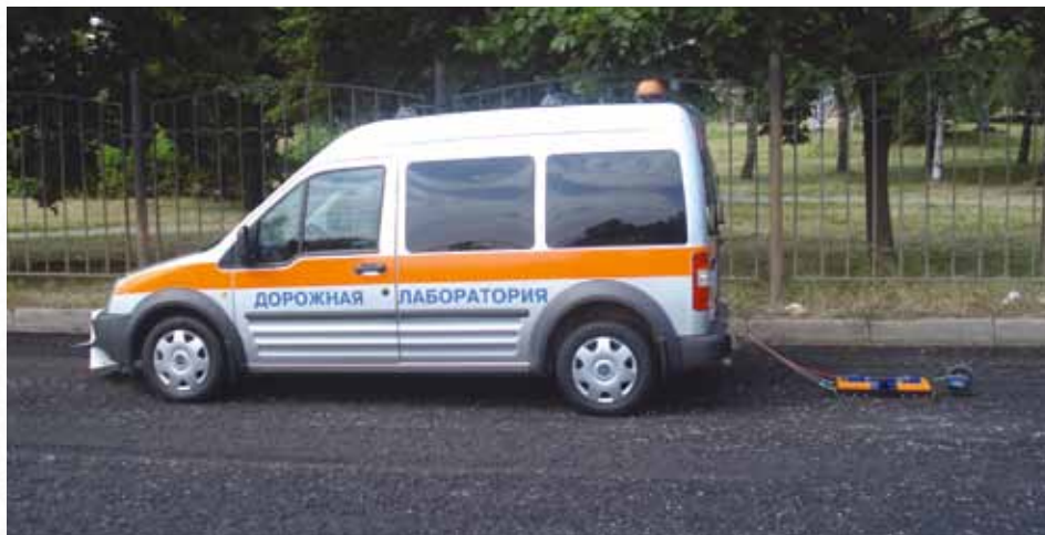
Рис. 1. Дорожная лаборатория ФГУП «РОСДОРНИИ» с георадарным оборудованием
