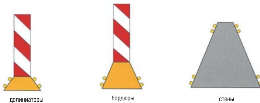
Рис. 5. Конструктивные направляющие элементы по нормам Германии
